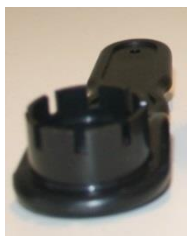
Ferramenta para rosquear a válvula.
